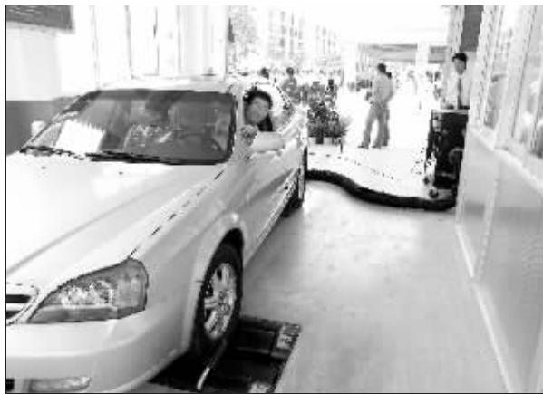
简易工况法测试系统模拟汽车运行状态进行检测。 时报记者 黄亦民 摄
